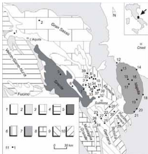
Fig.1 - Schema idrogeologico dell'Abruzzo. 1 - Depositi terrigeni quaternari (aquitardo); 2 - Depositi terrigeni terziari (aquiclude). Idrostrutture carbonatiche: 3 - Gran Sasso; 4 - Velino-Giano-Nuria; 5 - Sirente; 6 - Morrone; 7 - Majella; 8 - Montagna Grande; 9 - Genzana; 10 - Pizzalto-Porrara-Rotella. 11 - Punti d'acqua campionati.
